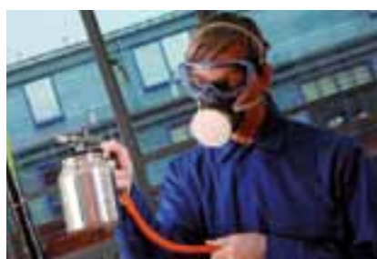
Полумаска 3M™ 3200 с комбинированным фильтром 3391 от органических газов и паров и аэрозолей
